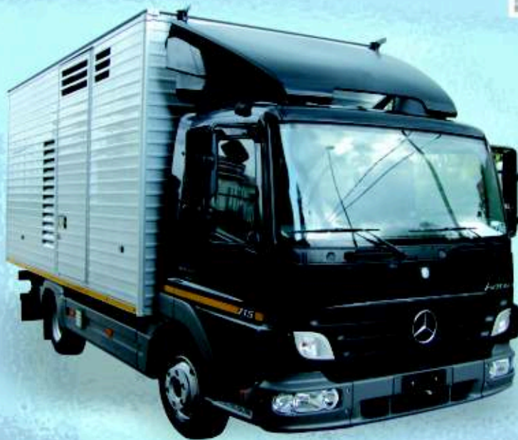
Centrale mobile di produzione energia elettrica
